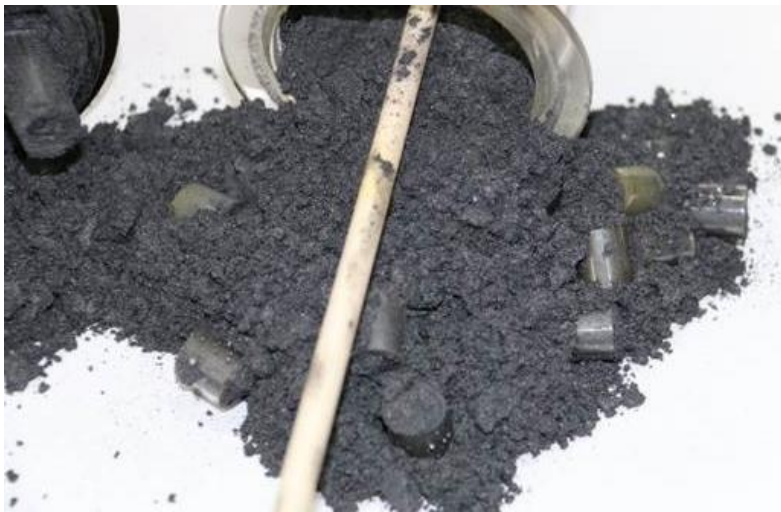
Elementares Kohlenstoffpulver entsteht neben Wasserstoff beim Cracken von Methan mit dem neuartigen Verfahren. (Bild: KIT)
