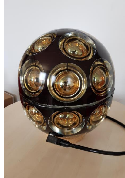
Prototyp eines der neuen Detektoren zur Messung der Tscherenkow-Strahlung im IceCube-Upgrade-Experiment. (Quelle: DESY, IceCube Collaboration)
