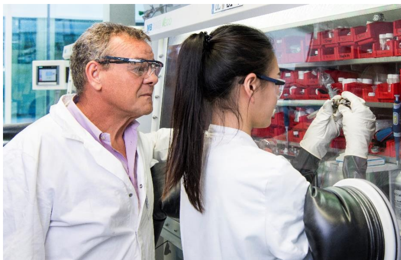
Professor Stefano Passerini und seine Mitarbeiterin Hyein Moon setzen an einer Handschuhbox eine Natrium-Ionen-Batterie zusammen. (Foto: Amadeus Bramsiepe, KIT)
