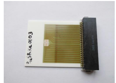
Die elektronische Nase ist ein Sensorchip, auf dem Nanodrähte mit Gerüchen – also komplexen Gasgemischen – reagieren. (Foto: Martin Sommer, KIT)
