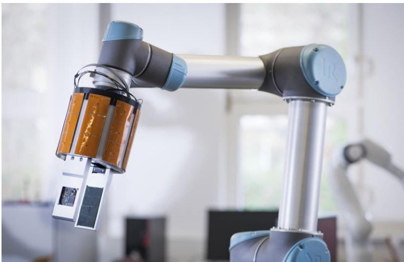
Robotergriffarm mit taktilen Näherungssensoren: Die multimodale Sensorik verbesserte die Kooperation zwischen Mensch und Roboter – und macht sie sicherer. (Foto: Amadeus Bramsiepe, KIT)
