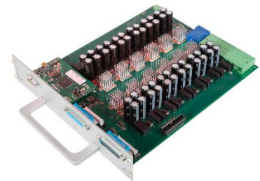
Einphasige Spannungsquelle des modular aufgebauten Power-Hardware-in-the-Loop-Systems (PHiL) zur leistungsstarken und hocheffizienten Nachbildung des elektrischen Energienetzes. (Foto: ETI, KIT)
