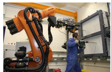
Das Power-Tool-Prüffeld (PTP) ermöglicht reproduzierbare Testbedingungen bei der Produktentwicklung. (Foto: IPEK, KIT)
