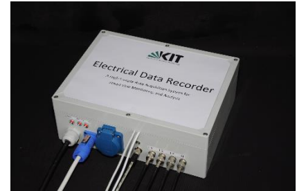
Der Electrical Data Recorder liefert hochaufgelöste Messdaten aus dem laufenden Netzbetrieb – sogar während eines Spannungsverlustes. (Foto: IAI, KIT)
