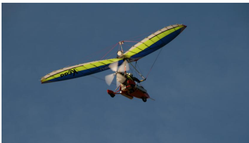
Fliegendes Labor: Im Ultraleichtflugzeug untersuchen die KIT-Klimaforscher Aerosole direkt in Höhe der Abluftfahnen von Kraftwerken. (Foto: Sylwester Arabas)
