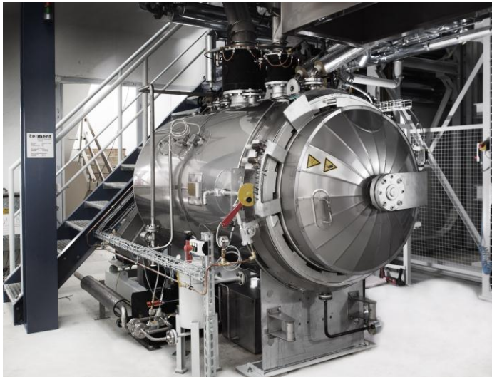
Hier wird der innovative Zement hergestellt: die Celitement-Pilotanlage auf dem Campus Nord des KIT. (Foto: Markus Breig)
