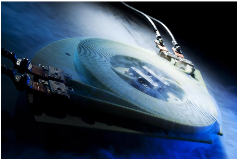
Supraleitende Spulen werden mit flüssigem Stickstoff gekühlt und bieten Strom keinen Widerstand. (Foto: Martin Lober, KIT)
