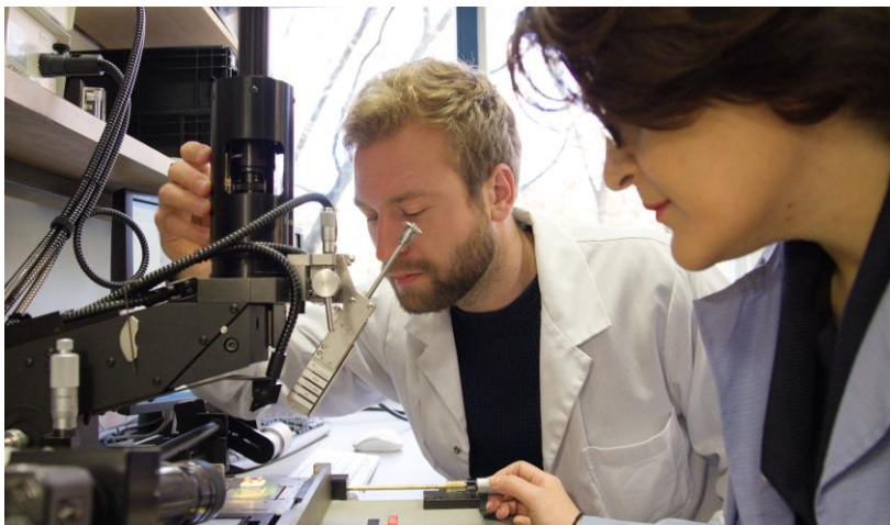
Sevda Abadpour und Axel Diewald vom Institut für Hochfrequenztechnik und Elektronik (IHE) des KIT positionieren einen Chip auf einer Platine. Gerade bei einer Größe im Mikrometerbereich muss alles perfekt ausgerichtet sein. (Foto: Joachim Hebel, KIT)
