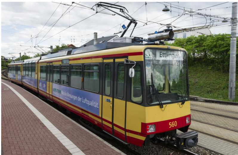
Die Bahn mit dem Instrumentenpaket über dem Führerhaus und dem AERO-TRAM-Schriftzug hat insgesamt 6228 Messfahrten hinter sich. (Patrick Langer, KIT).
