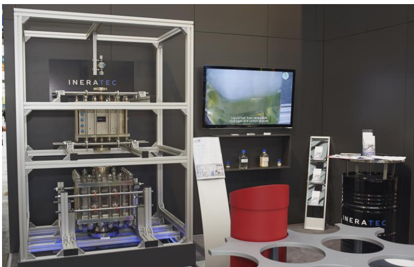
Der mikrostrukturierte Fischer-Tropsch Reaktor der Firma INERATEC verwandelt Gase in flüssige synthetische Kraftstoffe – vorgestellt wurde er auf der Hannover Messe 2017 (Foto: Andreas Drollinger)
