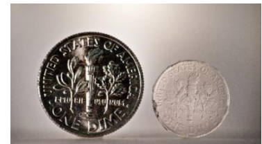
„Liquid Glass“ ist bei Raumtemperatur dickflüssig und lässt sich in jede beliebige Form bringen. (Foto: NeptunLab)
