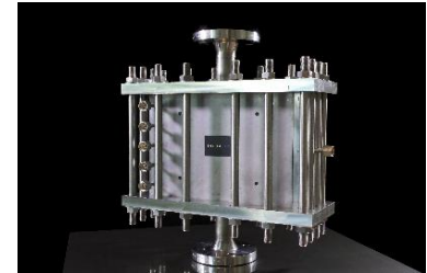
Der mikrostrukturierte chemische Reaktor kann methanhaltige Gase in flüssige synthetische Kraftstoffe von höchster Qualität verwandeln. (Foto: INERATEC/KIT)
