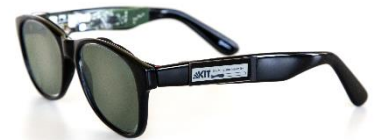
Solarbrille mit Gläsern aus semi-transparenten, organischen Solarzellen (Foto: Alexander Colsmann, KIT)
