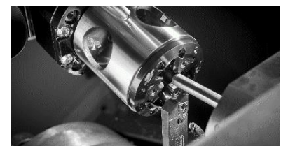
Das neue Verfahren ermöglicht eine gleichzeitige Dreh- und Wirbelbearbeitung von Bauteilen (Foto: Markus Breig, KIT)
