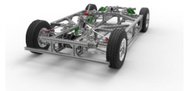
Demonstratorfahrzeug ELF++ zur Evaluierung einer Lenkkraftunterstützung durch radselektive Antriebe. (Abb.: Projektteam e 2 -Lenk)
