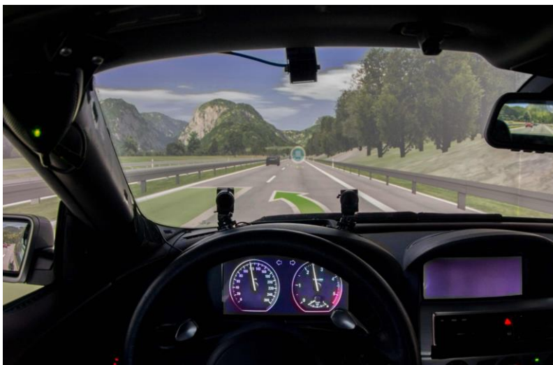
Ist der Autofahrer bereit das Steuer zu übernehmen? Mittels Kameras reagieren autonome Systeme abgestimmt auf die Lage im Innenraum. (Bild: PAKoS)
