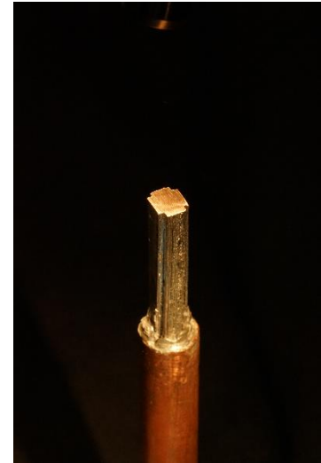
Der Innenleiter von CroCo ist aus flachen, supraleitenden Bändern unterschiedlicher Breite aufgebaut. (Bild: KIT)
