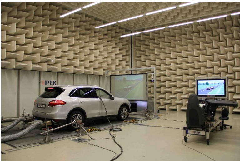
Im Mittelpunkt des Labornetzwerkes XiL-BW-e steht das interaktive und dynamische Zusammenwirken von räumlich getrennten Prüfständen. (Bild: KIT)
