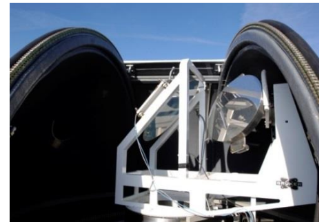
Kuppel für die optische Vertikalsondierung von Methan und Ethan (Foto: Ralf Sussmann, KIT)
