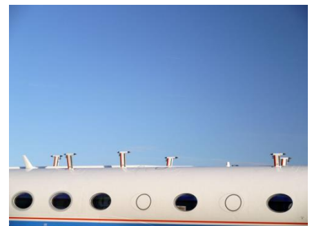
Über sieben Einlässe, die wie Igelstacheln aus dem Flugzeugrumpf herausragen, wird Atmosphärenluft angesaugt und zur chemischen Analyse in die in-situ Geräte an Bord geleitet. (Foto: Hermann Oelhaf, KIT)
