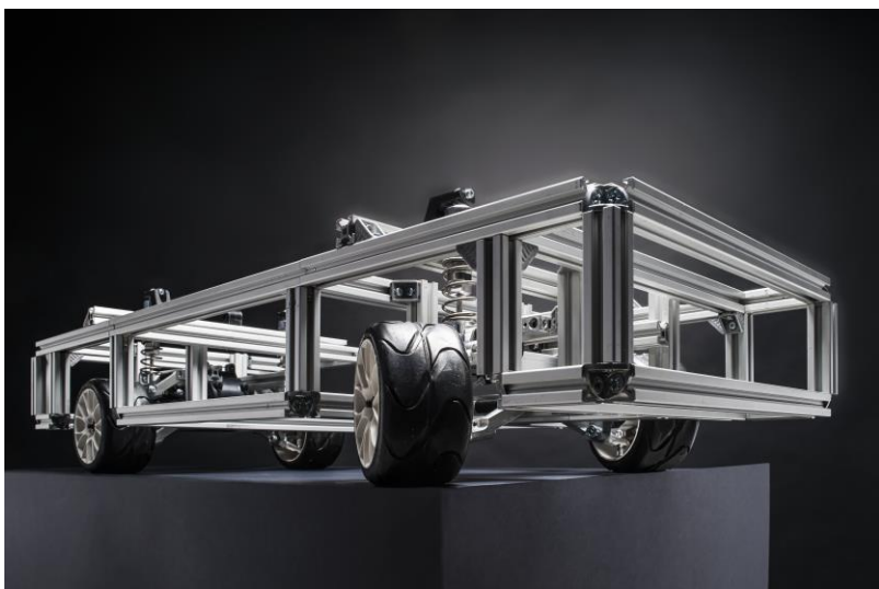
Mit dem Demonstrator im Modellmaßstab werden neue Antriebs- und Lenkkonzepte für Elektroautos am KIT getestet. (Foto: Markus Breig, KIT)
