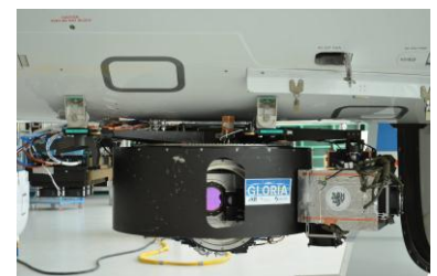
Das Infrarotspektrometer GLORIA nach der Montage unter dem Rumpf von HALO. (Foto: KIT)
