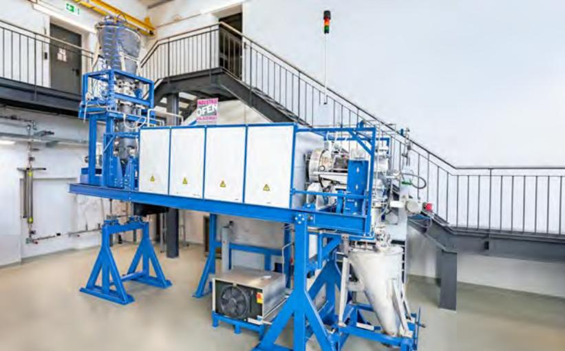
In der Pilotanlage am KIT wird Belit-Zementklinker in einem elektrisch beheizten Drehrohrofen bei unter 1 000 Grad Celsius aus bisher kaum genutztem feinem Betonbruch und Kalk produziert. [203]
