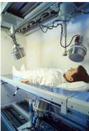
Abbildung 1: Eine Messung im Ganzkörperzähler am KIT
