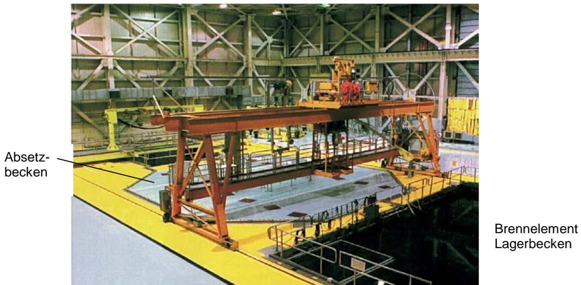
Abb. 2: Blick auf die Bedienungsebene mit Lademaschine eines SWR Containments vom Typ Mark I [2]
