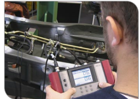
Funktionstest: Fahrzeugteilsysteme wie diese Traktorvorderachsfederung können auf dem Prüfstand vermessen werden.
