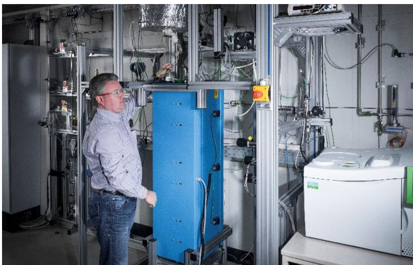
Der Versuchsreaktor zur Methanspaltung ist Teil des Flüssigmetalllabors am KIT (ausführliche Bildunterschrift am Textende; Foto: Amadeus Bramsiepe, KIT)
