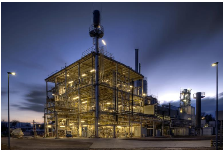
An der Karlsruher Pilotanlage bioliq wird erforscht, wie aus Biomasse hochwertige Kraftstoffe erzeugt werden können. (Bild: KIT)
